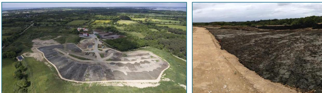
FIGURE 46 – REHABILITATION DE SITE (CET) A PARTIR DE SEDIMENT (LA LANDE DU MATZ - SARZEAU, IDRA 2015)
