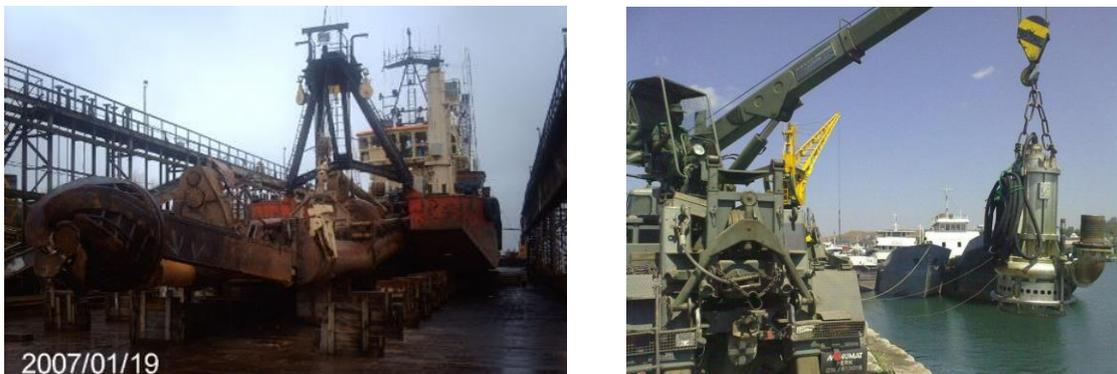
FIGURE 26 – DAS ANDRE GENDRE (SOURCE : DREDGEPOINT.ORG) ET POMPE TOYO (SOURCE : HYDROPLUSRENTAL.BE)
