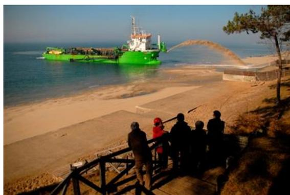
**FIGURE 21 – RECHARGEMENT DE PLAGE PAR RAINBOWING** (DAM MELLINA, PHOTO DEME GROUP)
